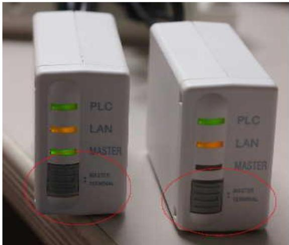
PLCアダプタの前面部の下側にMASTER（親機）とTERMINAL（子機）の切替スイッチがついています。親機は上側（MASTER）に、子機は下側（TERMINAL）に切り替えて下さい。
