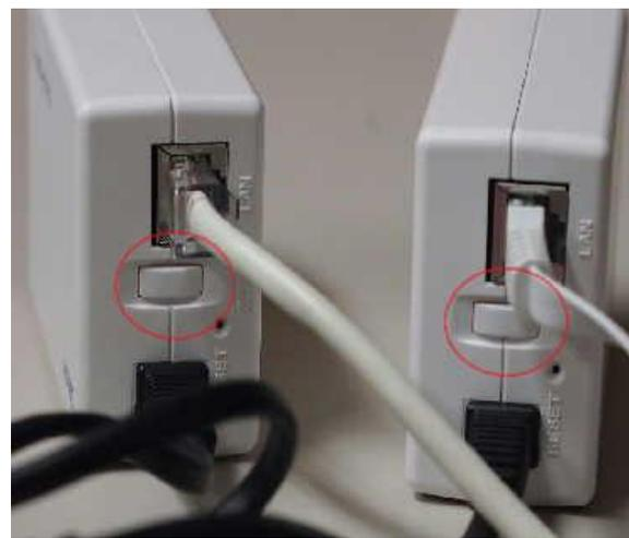
アダプター後面部中央に「SETUP」と書かれた白いボタンがあります。まず、親機の「SETUP」鈕を3秒以上押し、3秒以内に子機の「SETUP」鈕を3秒以上押しして下さい。
