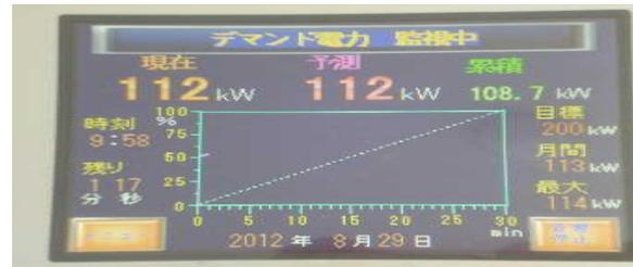
通信ができていない時にタッチパネル下側にエラー表示のバーが出ていますが、シーケンサとの通信が成立するとバーが消え、電力などの数値が表示され、時計の秒数が進みます。
