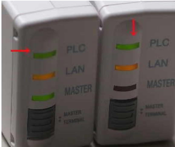
2個のアダプタの「PLC」ランプが何度か点滅したのち、点灯します。これで親子設定は完了です。「PLC」ランプが点灯しない場合は、登録が完了していません。最初からやり直して下さい。
