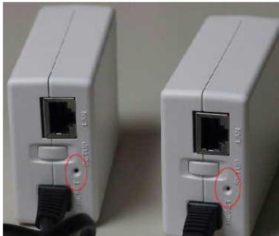
PLCアダプタの電源プラグをコンセントに接続します。次にPLCアダプタ後面部右側に「RESET」と書かれた小さな穴がありますので、これを先端の細いもので約3秒以上押しして初期化して下さい。アダプター前面部の3つのランプが点滅します。これで初期化は完了です。
