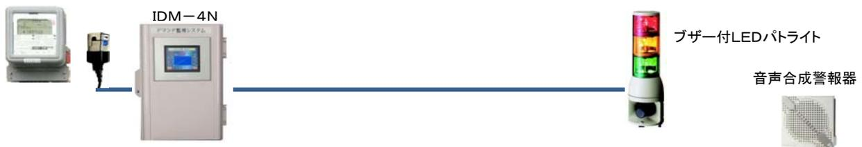
〈注〉IDM-4Nはパワーサプライを内蔵していませんので、パトライトは別電源で点灯させて下さい。必ず有線配線が必要です。
