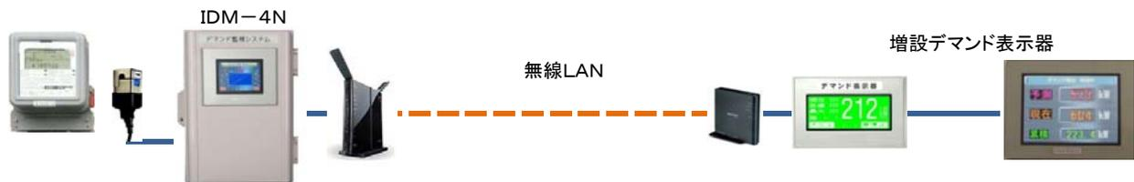
〈注〉有線LAN、無線LAN、PLCを利用して簡単にデマンド表示器を標準で4台まで(最大10台)増設できます。
