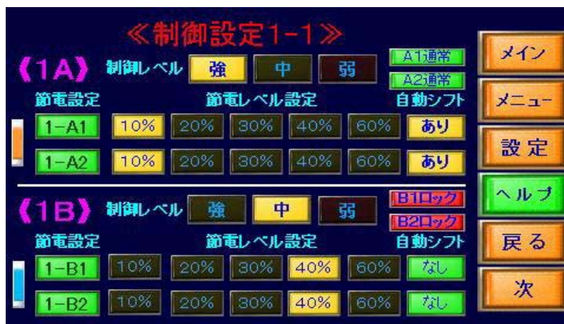
IDM－EMSのエアコン制御・節電設定画面
